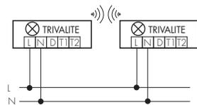
Per la comunicazione tra più lampade, in alternativa al filo dati, si può installare una rete di radiocomunicazione. Tali reti funzionano senza limitazione anche in maniera trasversale tra i gruppi fusibili.
